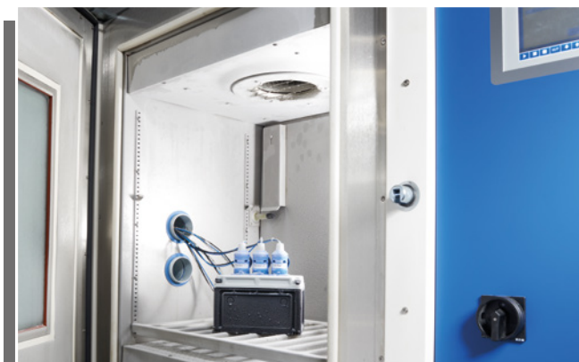
Dlouhodobý test v klimatizační komoře při teplotě -40°C
