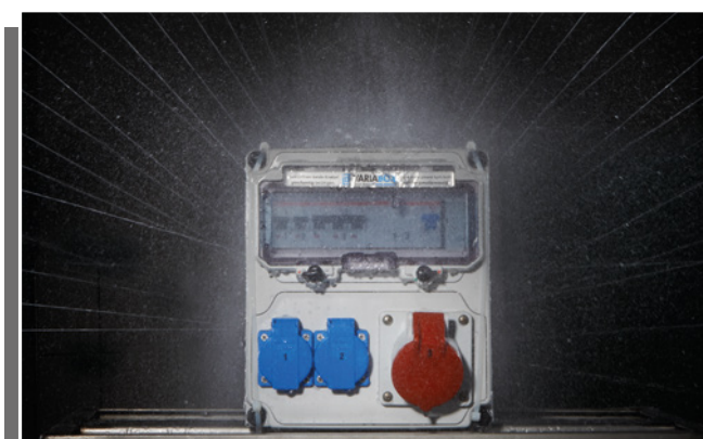
Testování odolnosti proti stříkající vodě
