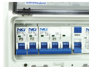
Pokud zákazník nespecifikuje vlastní konfiguraci, pro CEE-zásuvky standardně instalujeme jističe charakteristiky C a jejich hodnoty odpovídají vždy jmenovitému proudu osazených zásuvek.
